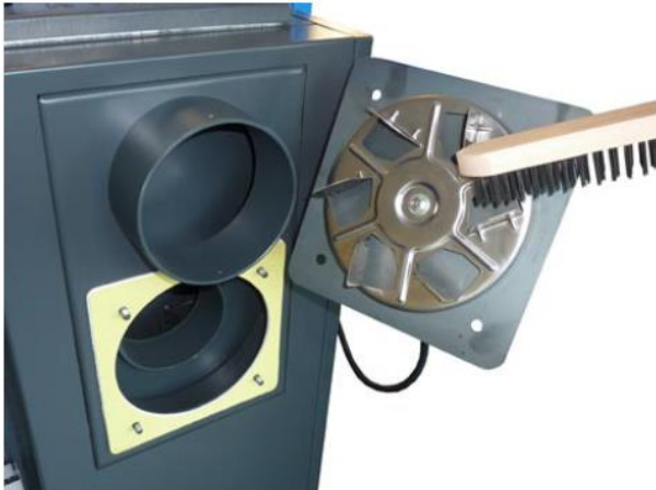
Exemplu pentru curățarea căilor de fum cu perie de sârmă – partea superioară
